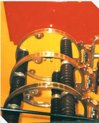
Colector III+T de 15 KV 400 A, montado en arrollador.
