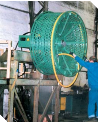
Montaje en fabrica de cable en arrollador de cable spreader.
